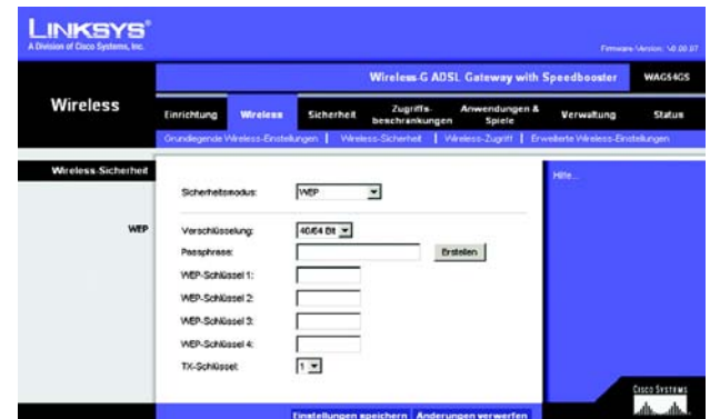
Abbildung 6-19: Wireless Security Sicherheit im Wireless-Netzwerkbetrieb – WEP
